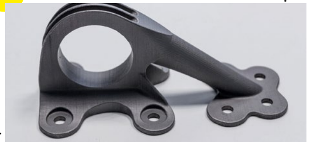
Großes Aufsehen erregte der Prototyp einer Halterung, die mit 3D-Druckern im Laserschmelzverfahren aufgebaut wurde. Dieses Verbindungselement für Flugzeuge wurde früher aus Alu gefräst.
